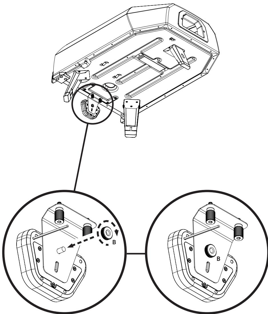
**Korak 4b - Pričvrstite digitalni termometar**
