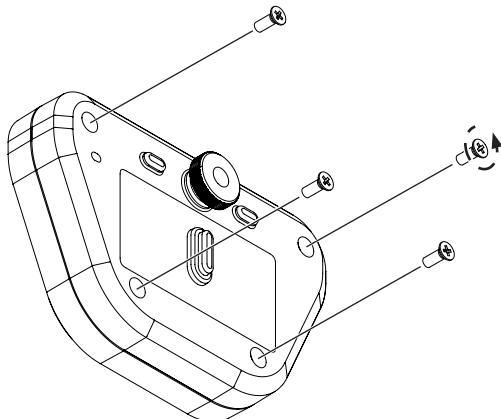
Uklonite 4x Phillips vijka u smjeru suprotnom od kazaljke na satu s poklopca baterije
