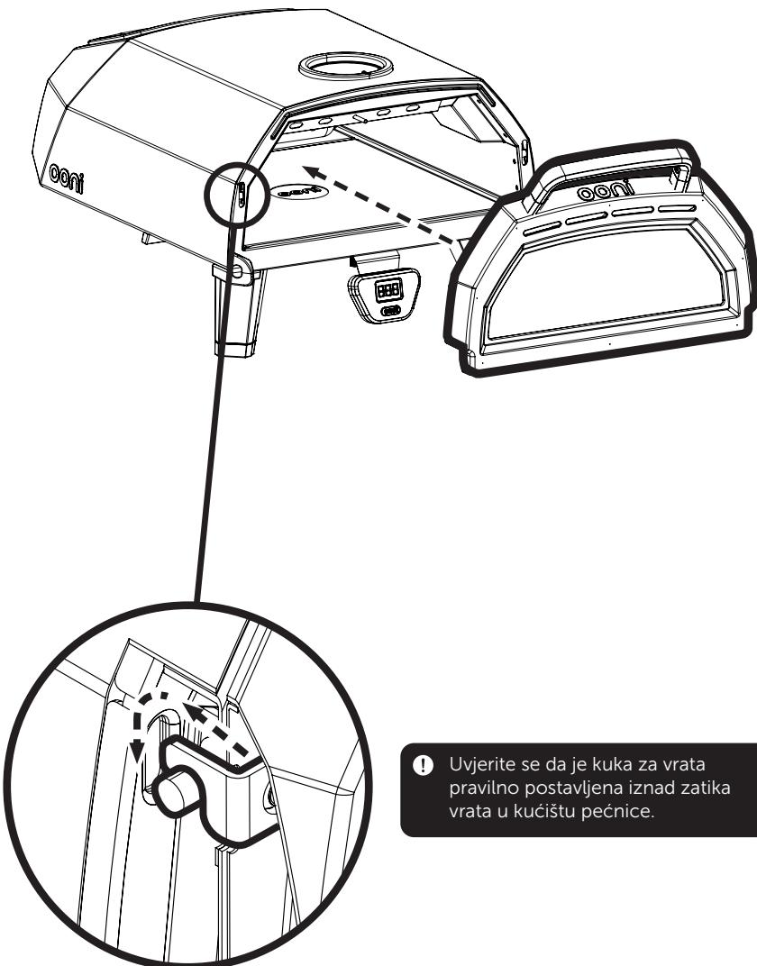
! Uvjerite se da je kuka za vrata pravilno postavljena iznad zatika vrata u kućištu pećnice.
