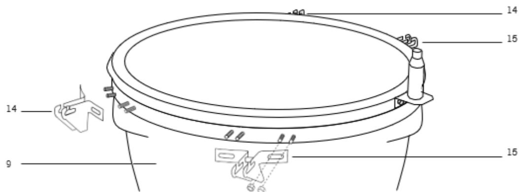
**KORAK 12** - Pričvrstite 2x nosača stola (14) na Kamado (9) pomoću 4x unaprijed pričvršćenih vijaka i matica s kupolastom glavom po nosaču. Imajte na umu položaj prikazan na gornjem dijagramu
