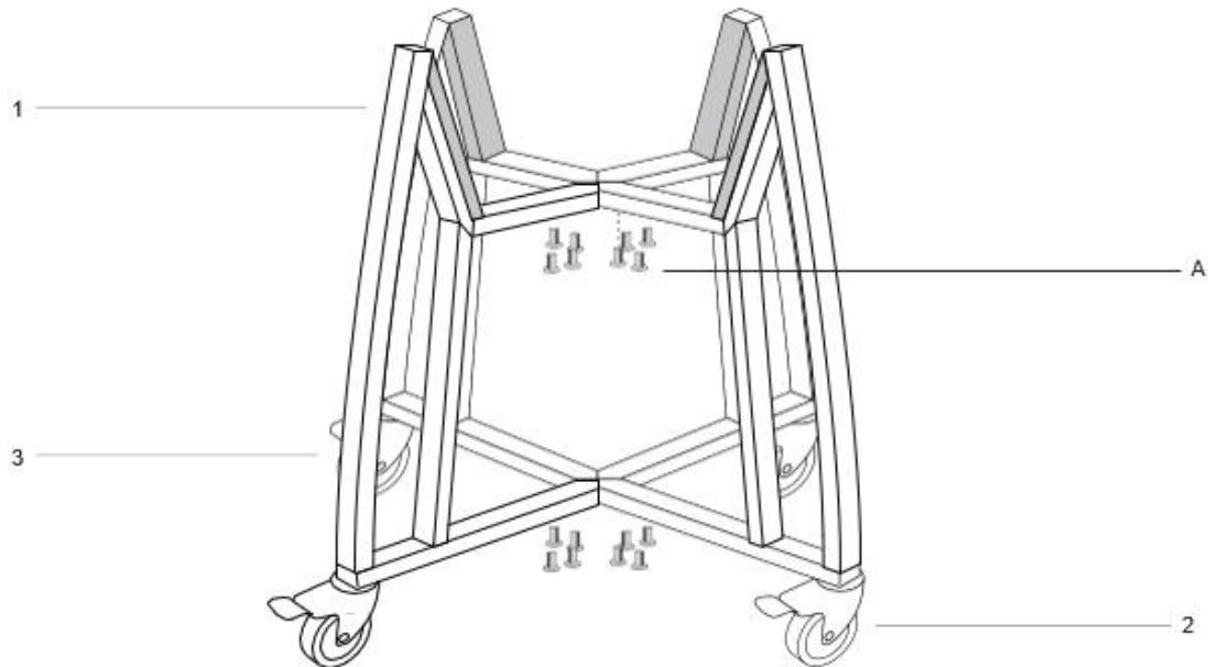
**KORAK 3** - Nastavite umetati poprečne dijelove (4) u ostala tri nosača (1).
