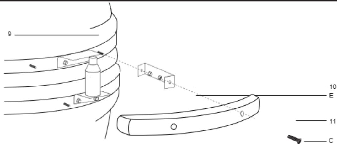
**KORAK 10** - pričvršćivanje ručke (10) na poklopac Kamada (9) započnite pričvršćivanjem 2x nosača ručke (11) pomoću 2x prethodno pričvršćenih vijaka i matica s kupolom. Pričvrstite ručku (11) na nosače (10) pomoću 2x vijaka (C) i matica (E).
