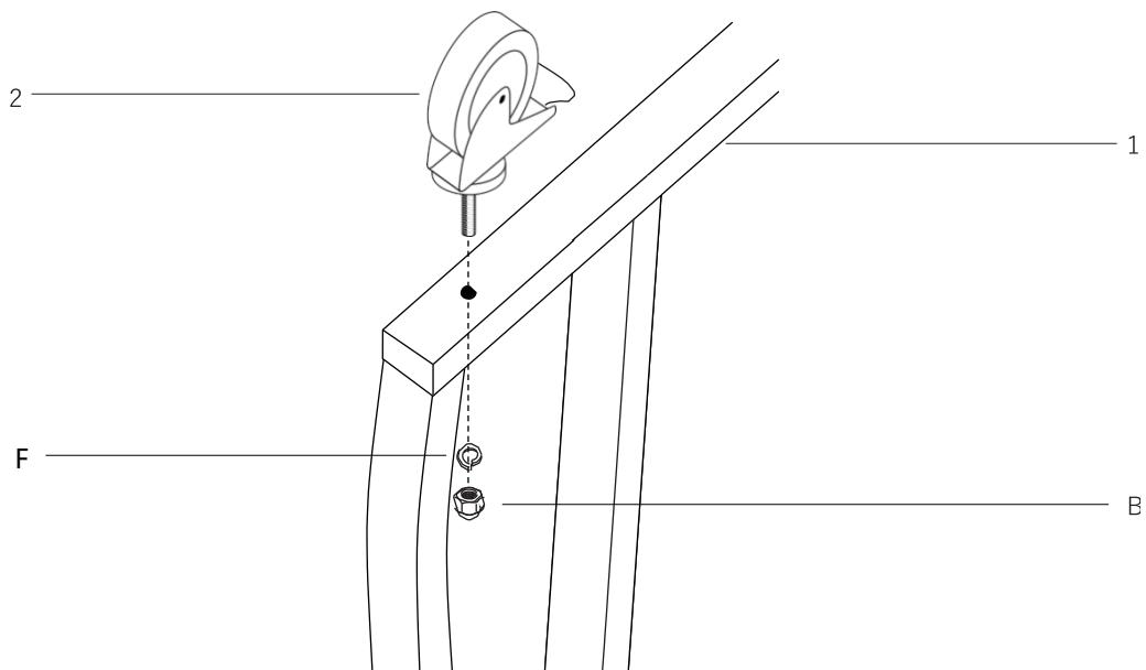
**KORAK 1** - Pričvrstite četiri kotača s navojem (2 i 3) na svaki od četiri nosača (1) pritiskujući ih kroz rupu. Pomoću podesivog ključa učvrstite svaki točkić s 1x maticom (B).
