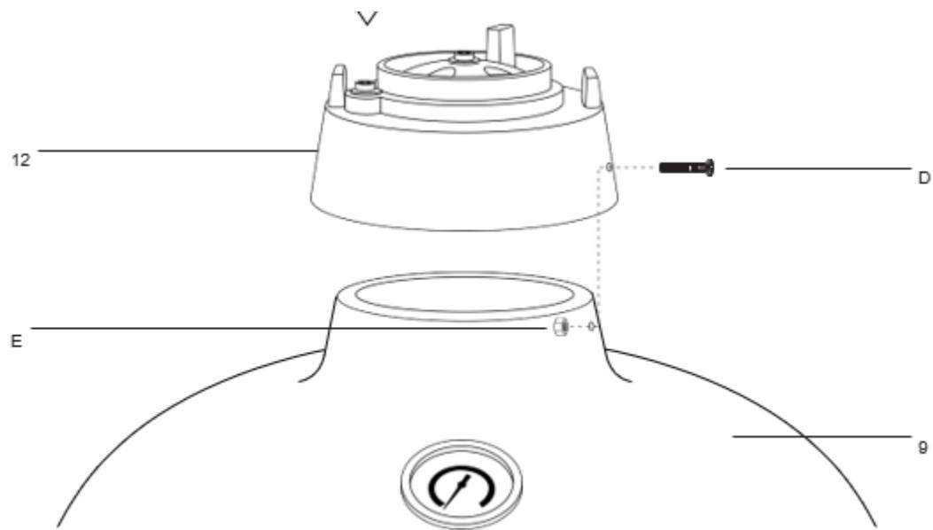
**KORAK 11** - Da biste pričvrstili gornji otvor za odzračivanje (12) na Kamado (9), postavite ga na vrh i poravnajte obje rupe za vijke. Učvrstite pomoću 2x vijaka (D) i matica (E). Prilikom montaže osigurajte da je gornji vijak za odzračivanje s lijeve strane.
